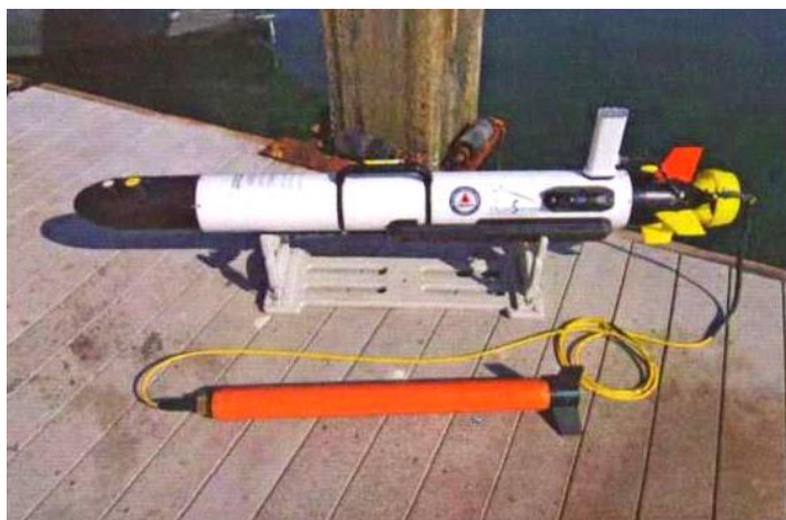
Рис. 1. AUV Iver 3 з магнітометром Marine Magentics
