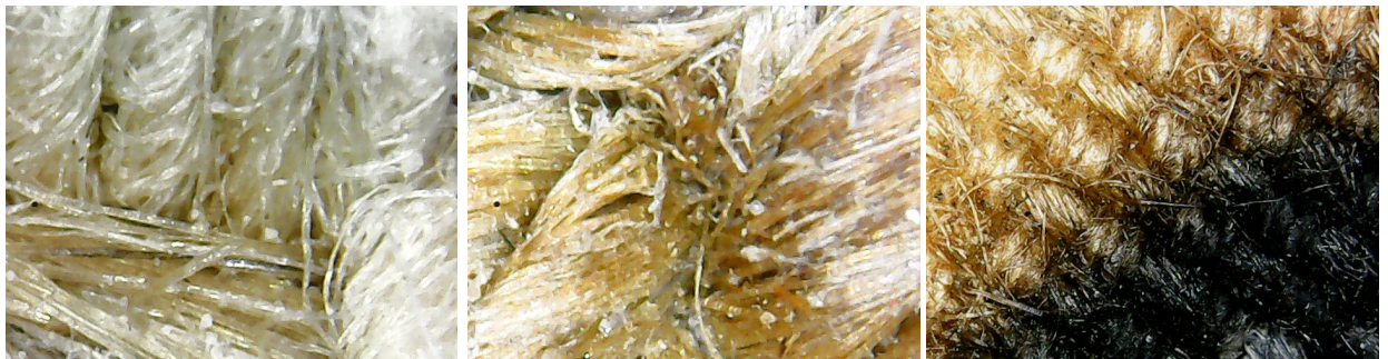
Рис. 2.6. Мікроструктура покриттів по бавовняних тканинах на основі: а) метилтриетоксисилану, б) етилсилікату-32 та в) кремнекислоти
