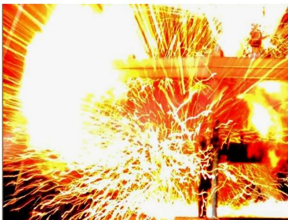
**Рис. 3.** Начальная стадия ЭВ медной жилы сечением  $S_1 \approx 3,2$  мм<sup>2</sup> ОО радиочастотного коаксиального кабеля марки РК 50-7-11 со сплошной ПЭТ изоляцией длиной 0,5 м в сильноточной разрядной цепи генератора типа ГИТМ-10/350
