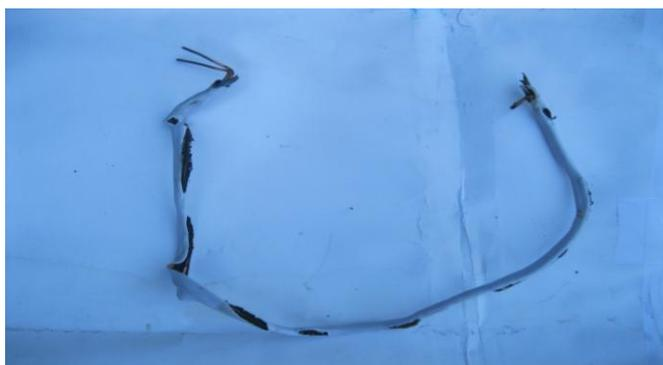
**Рис. 6.** Внешний вид фрагмента ОО провода марки ПНП 2х2,5 с ПВХ изоляцией
