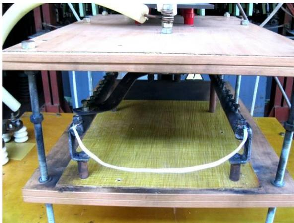
**Рис. 5.** Стол генератора типа ГИТМ-10/350 с закрепленными на его стальных электродах сплошными круглыми медными жилами общим сечением  $S_1 \approx 5 \text{ мм}^2$  ОО провода марки ПНП 2х2,5 с ПВХ изоляцией длиной 0,5 м до воздействия на них аперiodического импульса тока 15/335 мкс искусственной молнии амплитудой около  $I_{mL} \approx 85,6 \text{ кА}$  ( $U_{31-3} \approx 16,5 \text{ кВ}$ ;  $U_{34} \approx 4,2 \text{ кВ}$ )
