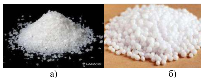
Рис. 3. Модифіковані добавки другого типу: а) NH_4Br ; б) CO(NH_2)_2 .
