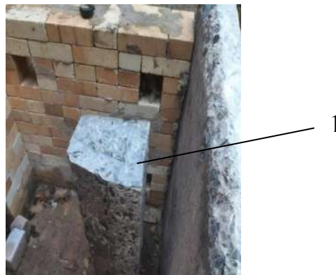
Рис. 1. Малогабаритний фрагмент залізобетонної колони, виготовленої заздалегідь до випробування: 1 фрагмент заздалегідь виготовленої залізобетонної колони.
