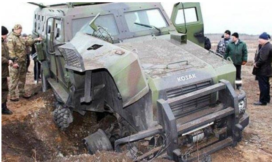
Рис.2 – Український броневантажівка КОЗАК-2 після проведення випробування шляхом імітації наїзду на протитанкову міну вагою бкг
