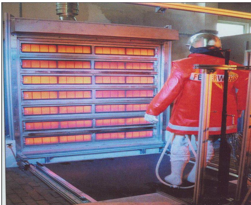
Рис. 1.5 - Стенд теплових панелей, який використовується для випробування захисного одягу [90]
