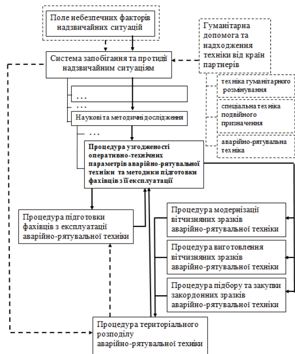
Рис. 1. Структурно-логічна схема процесу узгодження та підвищення ефективності системи підготовки фахівців з експлуатації аварійно-рятувальної техніки в умовах повсякдення та умов воєнного часу
