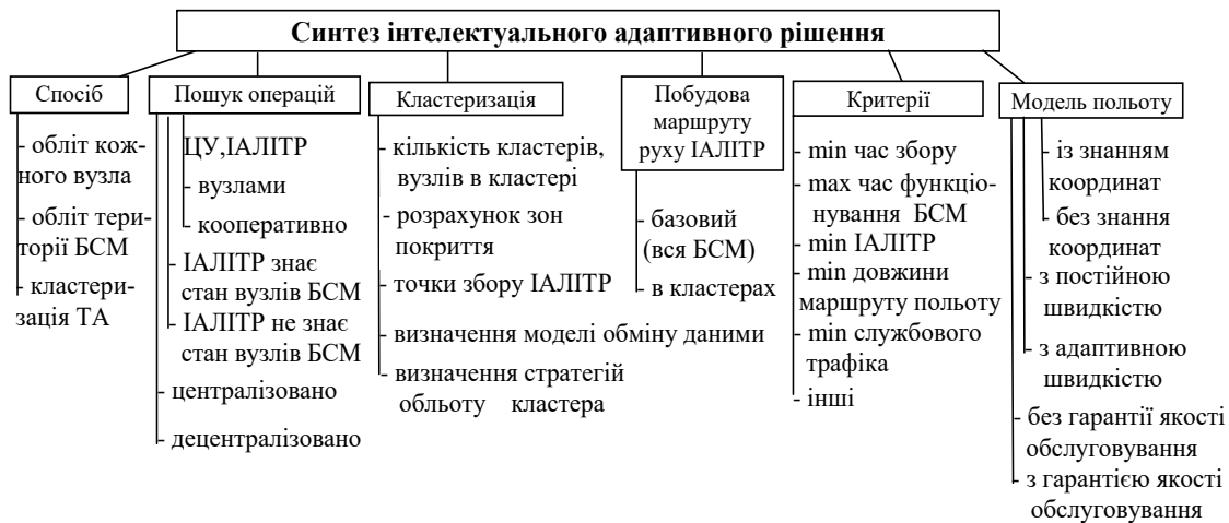
Рисунок 1. Структура системного підходу стосовно вибору раціонального способу збору інформації з вузлів БСМ
