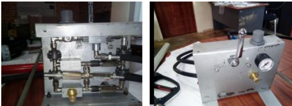
Рис. 3. Загальний вигляд багатофункціонального пульта керування прототипу дослідного зразка системи з генерування компресійної піни.
