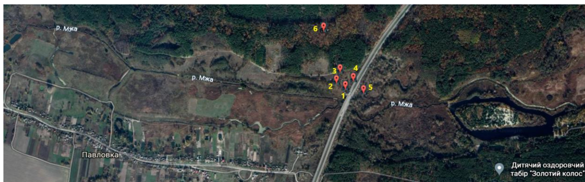
Рис. 3 – Дорога М-29 Харків-Дніпро (досліджувана ділянка: 20 км – 22 км) Умовні позначення: 1 - 5 – точки прямих вимірів стану атмосферного повітря; 1- 3, 5 – точки відбору проб ґрунту та рослинності; 6 – точка відбору контрольних проб рослинності та ґрунту
