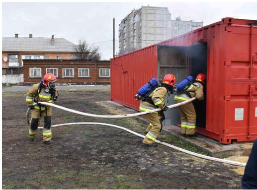
Рис. 2 – Контейнер моделювання динаміки пожежі (наступального типу)
