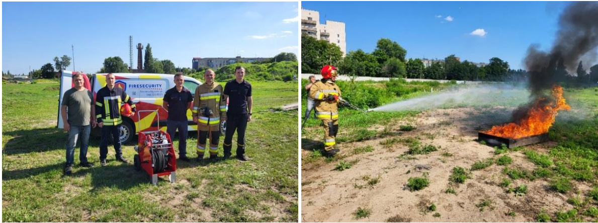
Рис. 7 – Проведення експериментальних досліджень під час гасіння модельних осередків пожежі із застосуванням обладнання «Firexpress»
