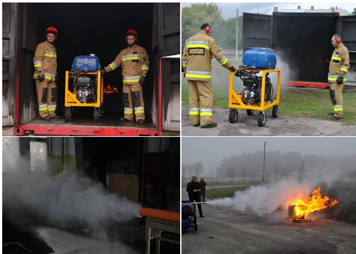
Рис. 6 – Проведення експериментальних досліджень із застосуванням установки пожежогасіння періодично-імпульсної дії
