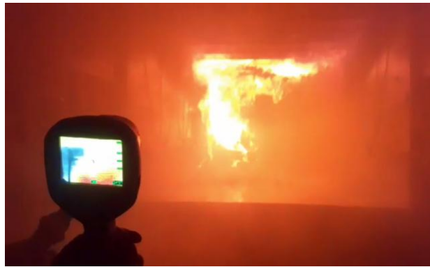
Рис. 2 – Контейнер моделювання динаміки пожежі (наступального типу)
