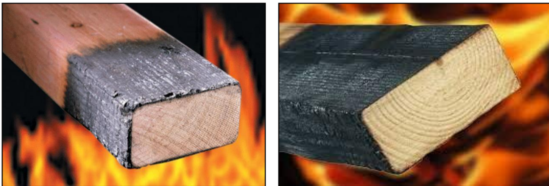
Рис. 7.2 – Зразки деревини з вогнезахистом після температурного впливу
