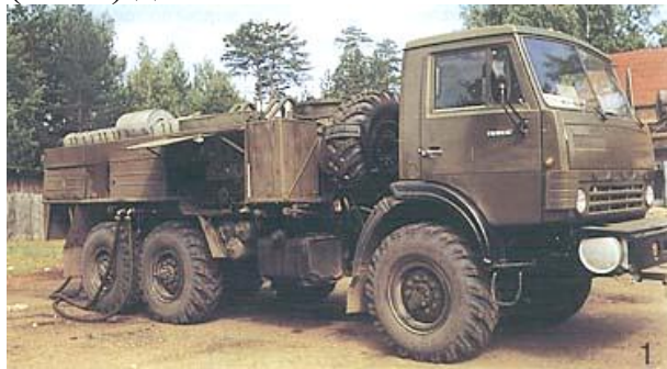
Рис. 9.5. Авторозливодна станція АРС-14
