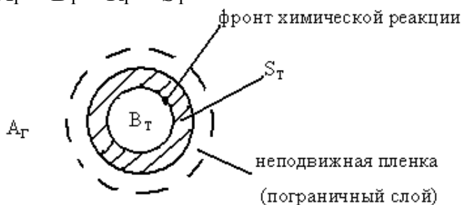
Рис. 2.2– Механізм взаємодії між газом і часткою твердого тіла
