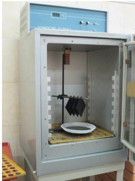
Рис. 2.2 Вертикальні пластини і піддони з мазутом, розміщені в термошафі
