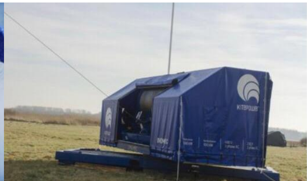
Рисунок 3. – Силовий агрегат системи з лебідкою і електрогенератором
