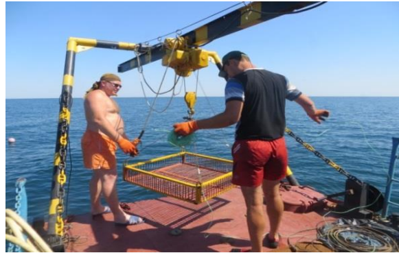
Рисунок 2. – Підйом «кошика» з вибухонебезпечним предметом на борт теплоходу
