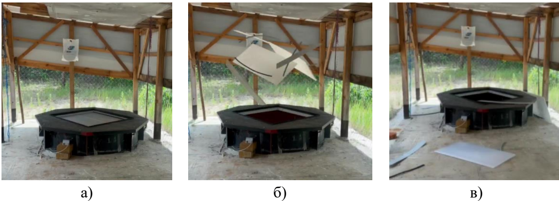
Рис. 1. Випробування зразка модульної світлопрозорої легкоскидної конструкції: а – до випробувань; б – факт спрацювання; в – після випробувань
