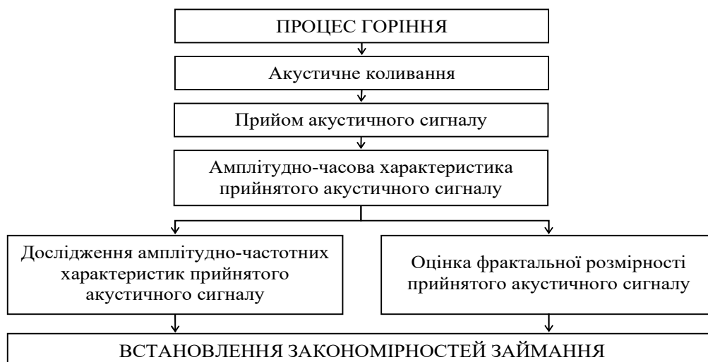
Рисунок 4 – Послідовність встановлення природи кінетичних ефектів високотемпературного окиснення (горіння) деяких рідких органічних речовин методом акустичної емісії
