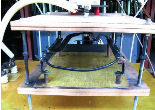
Рисунок 6 – Общий вид рабочего стола мощного высоковольтного генератора типа ГИТМ-10/350 с закрепленной на его массивных стальных электродах сплошной круглой алюминиевой жилой сечением S_1 \approx 6 мм 2 ОО провода марки АППВнг2х6 с ПВХ изоляцией длиной 0,5 м до воздействия на нее аperiodического импульса тока 15/335 мкс искусственной молнии амплитудой около I_{mL} \approx 85,6 кА ( U_{31-3} \approx 16,5 кВ; U_{34} \approx 4,2 кВ)
