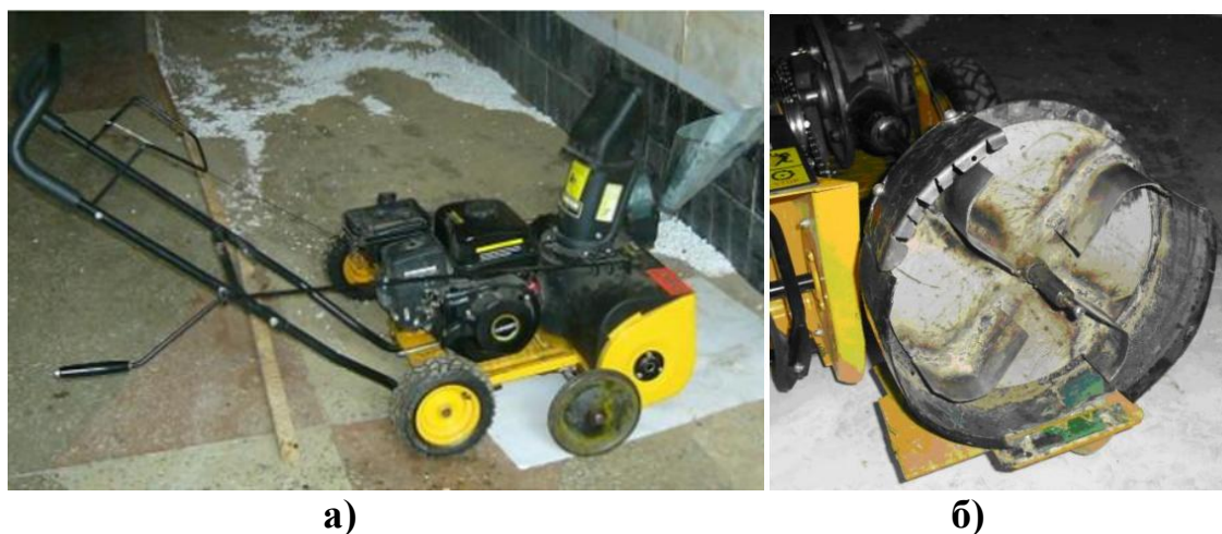
Рис. 1. Экспериментальный образец грунтометательной машины: а) общий вид машины; б) рабочий орган машины с лопатками
