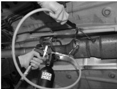
Рисунок 4 – Система очищення ФТЧ від ТЧ (примусової регенерації I роду в аварійно-штатному режимі) виробництва фірми LIQUI MOLY ( http://liquimoly.ua/Dizelnyy-sagevyuy-filtr-ochistka-vmesto-remonta-i-odnovremennaya-ekonomiya )
