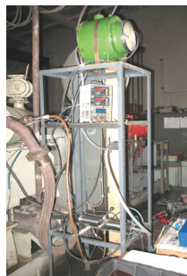
Рис. 2. Модернізована випускна система МВС, обладнана МВ і системою відбору проб ВГ на токсичність і димність: а — загальний вигляд; б — стояк з приладами; в — макетопідтримувальна вставка
