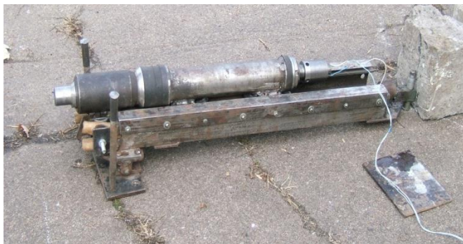
Рисунок 5 - Водяная система пожаротушения импульсного действия для тушения газовых фонтанов
