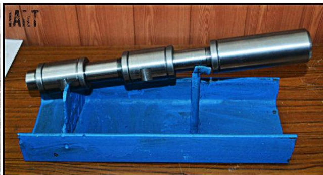
Рисунок 6 - Устройство гидроимпульсного разрушения элементов строительных конструкций
