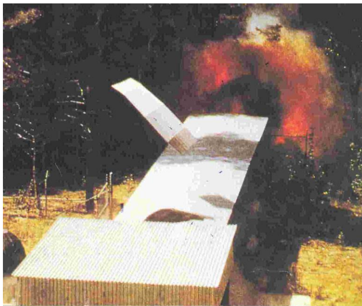
Рисунок 7 - Взрывная камера для создания и изучения воздействия взрыва на строительные конструкции
