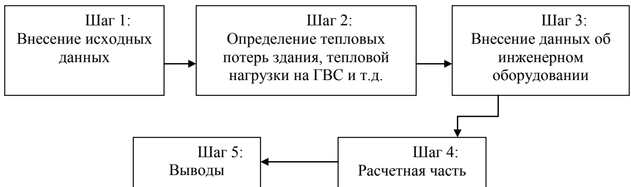
Рис. 1 – Схема работы компьютерной программы по расчету комбинированной инженерной системы для энергоэффективного дома
