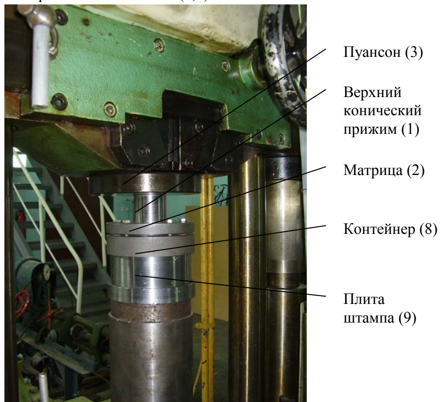
Рисунок 2 - Универсальная гидравлическая машина ЦДМПУ-10 с установленным экспериментальным штампом
