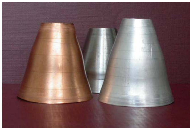
Рисунок 4 - Детали выпуклой формы, полученные по предлагаемому способу
