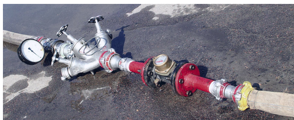
Рис. 3. Измерительная аппаратура для проведения эксперимента по определению гидравлических параметров и характеристик НРС
