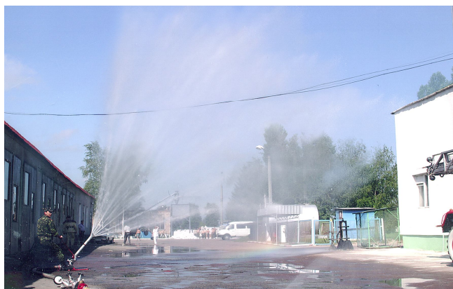
Рис. 4. Момент проведения эксперимента по определению основных гидравлических параметров и характеристик НРС
