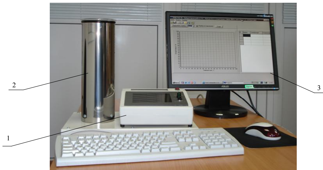
Рис. 2. Внешний вид установки: 1 – электронный блок управления; 2 – экспериментальный модуль; 3 – персональный компьютер
