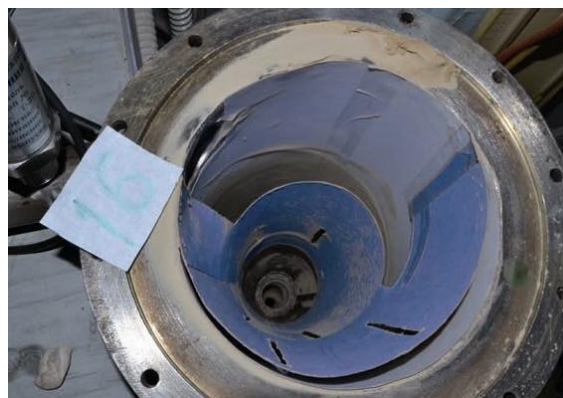
Рис. 2. Состояние поверхностей при использовании щелевых улавливающих отверстий
