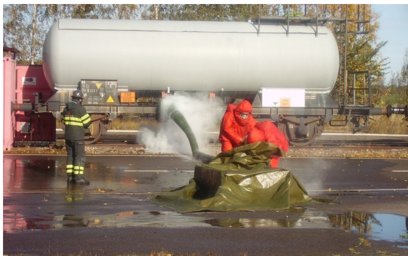
Рис. 1. Локализация химических аварий с использованием способа повторной конденсации
