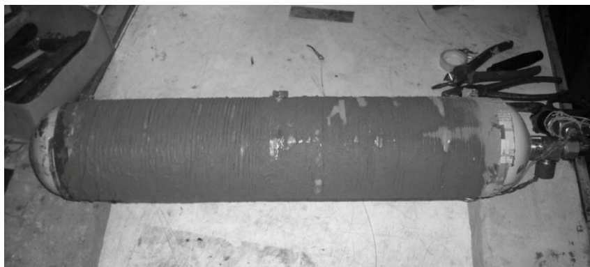
Рис. 5.31. Фото композитного баллона, используемого в эксперименте
