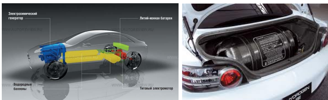
Рис. 2.1. Способы расположения баллонов с водородом в автомобиле [119,120]
