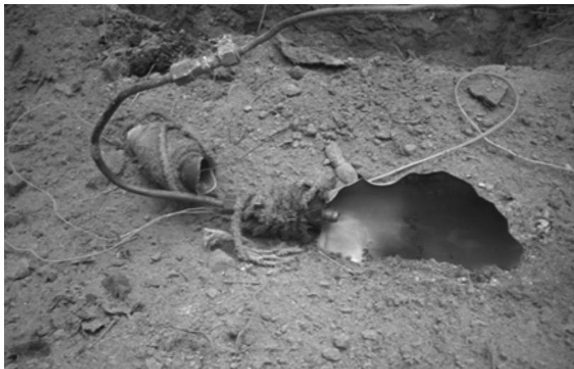
Рис. 5.23. Фото гидридного патрона после взрыва
