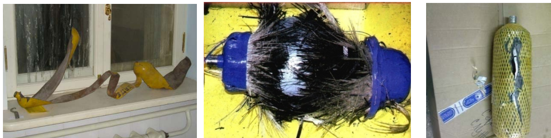
Рис. 2.3. Фото разрушенных баллонов
