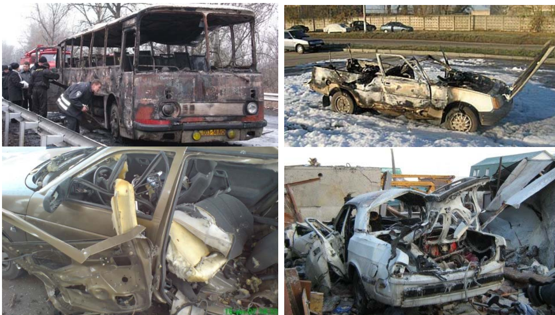
Рис. 1.16. Последствия аварийных ситуаций, связанных с газобаллонной системой хранения топлива на автомобиле
