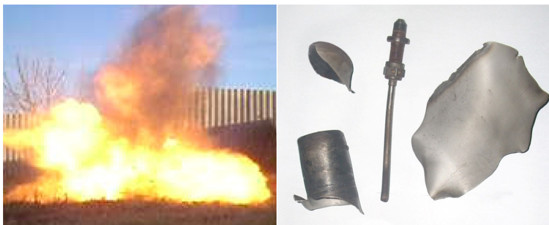
Рис. 5.17. Фото взрыва и гидридного патрона после взрыва
