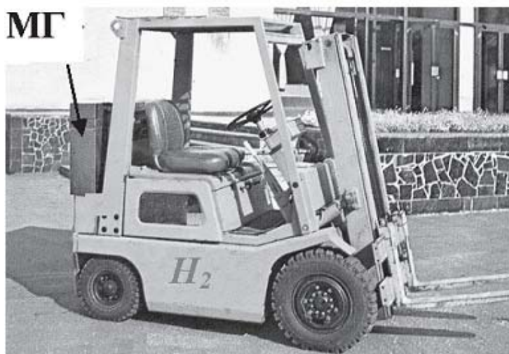
Рис. 4.3. Погрузчик, использующий систему хранения водорода на основе обратимых гидридов интерметаллидов
