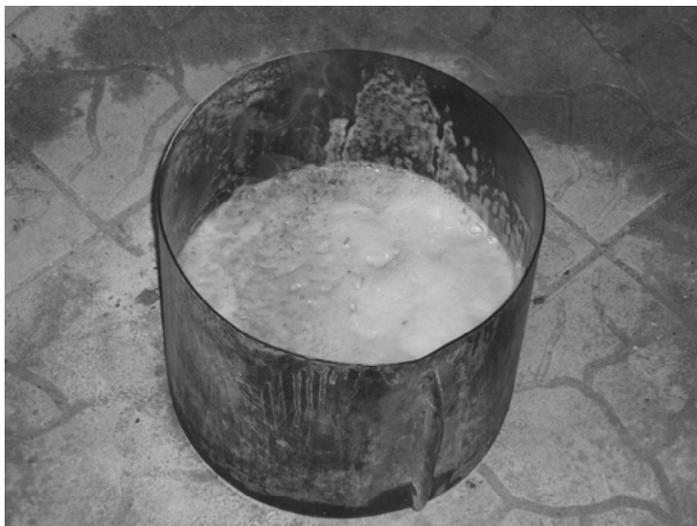
**Рис. 2 – Пена, образовавшаяся на поверхности бензина после прекращения горения**
