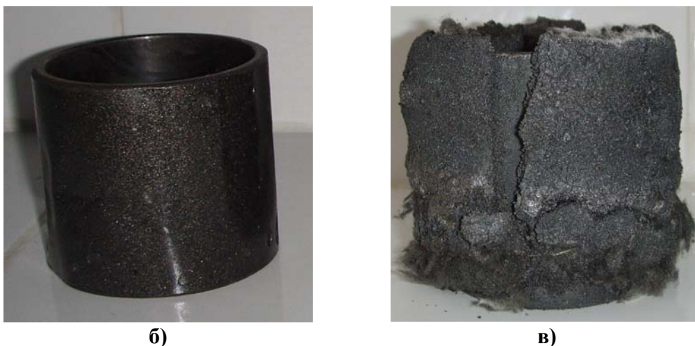
Рис. 1 – Вигляд зразків з реактивним покриттям ОВК товщиною 1мм в початковому стані (а) та після нагрівання з темпом 40^{\circ}\text{C}/\text{хв.} (б).
