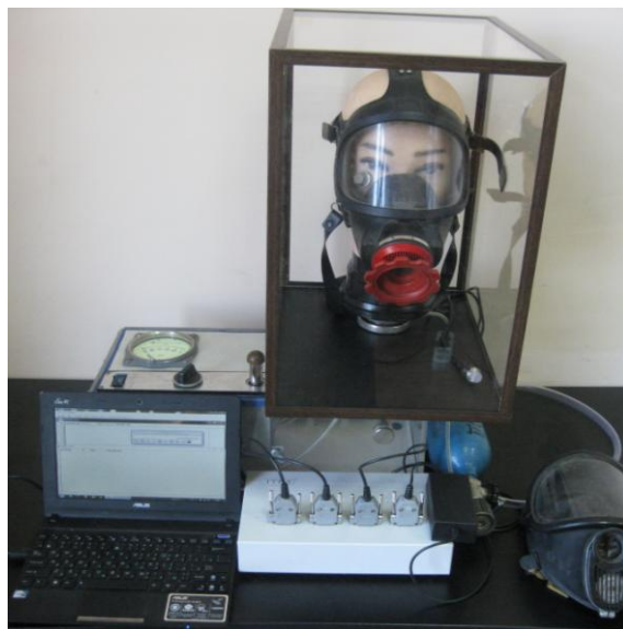
Рис. 1. Установка для дослідження лицьових частин ізолюючих апаратів: 1 – купол; 2 – макет голови людини; 3 – аеротест; 4 – аналогово-цифровий прилад; 5 – газоаналізатор; 6 – реометр; 7 – газовий балон; 8 – персональний комп'ютер з програмним забезпеченням
