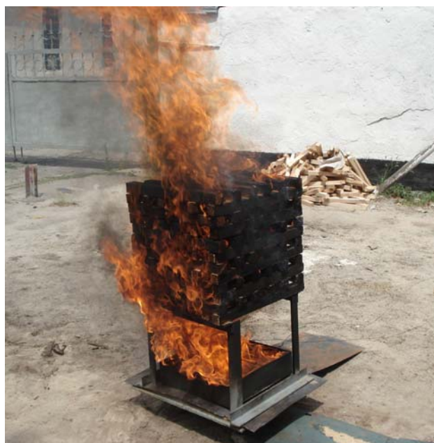
Рис. 3 – Внешний вид стандартного модельного очага 1А установленного на весах непрерывного взвешивания (закрты теплозащитным экраном)
