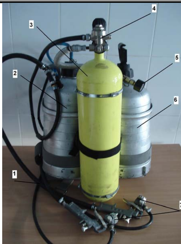
Рис. 2 – Внешний вид автономной установки пожаротушения ГОС «АУТГОС–П»
