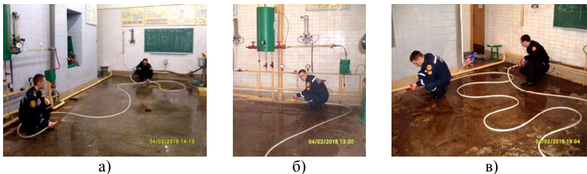
Рис. 1. Вимірювання втрат напору та витрат води з ПКК при змінах напору в мережі та відстані між манометрами (ступінь розгортання рукава): а) 5,76 м (40 %); б) 9,65 м (67 %); в) 1,87 м (13 %)
