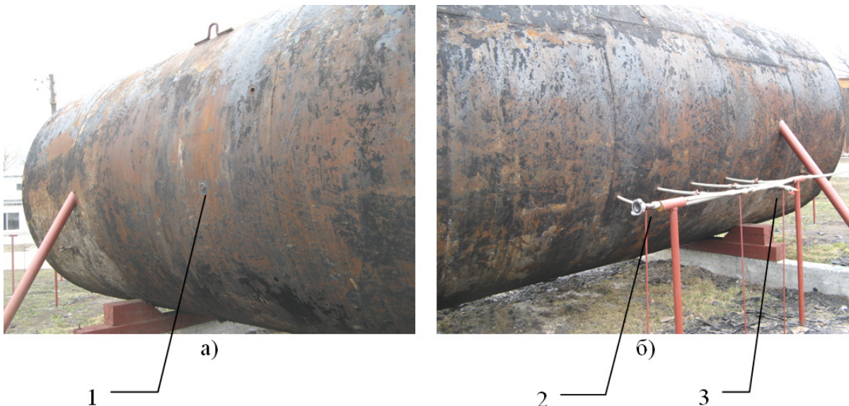
Рис. 2 – Внешний вид экспериментальной установки спереди (а) и сзади (б): 1 – выходное отверстие; 2 – разъем для подключения насоса; 3 – система труб
