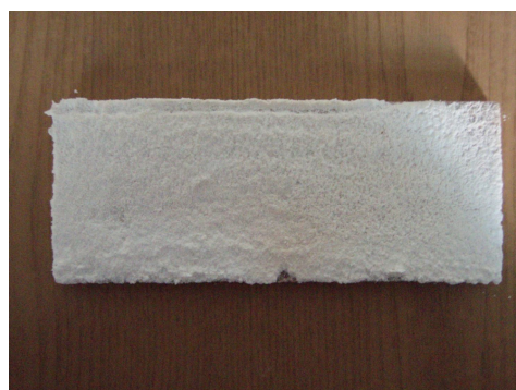
Рис. 3.6 б Образец древесины покрытый ксерогелем при введении в раствор \text{Na}_2\text{O}\cdot 2,95\text{SiO}_2 асбеста 30 \text{ г}\cdot\text{л}^{-1}
