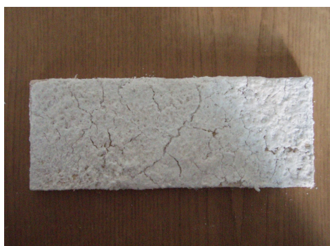
Рис. 3.6 а Образец древесины покрытый ксерогелем ГОС \text{Na}_2\text{O}\cdot 2,95\text{SiO}_2 - \text{CaCl}_2
