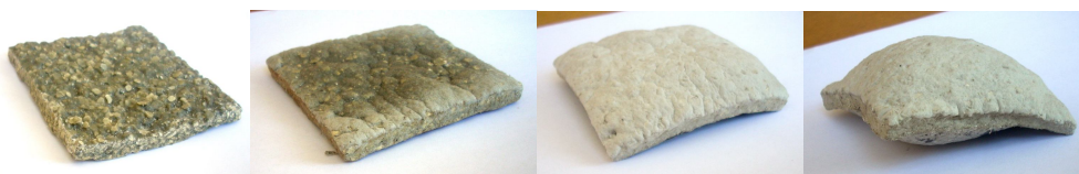
Рис. 4.6. Образцы ксерогеля ГОС при прогреве до температур, °С: 20, 150, 200, 250 соответственно
