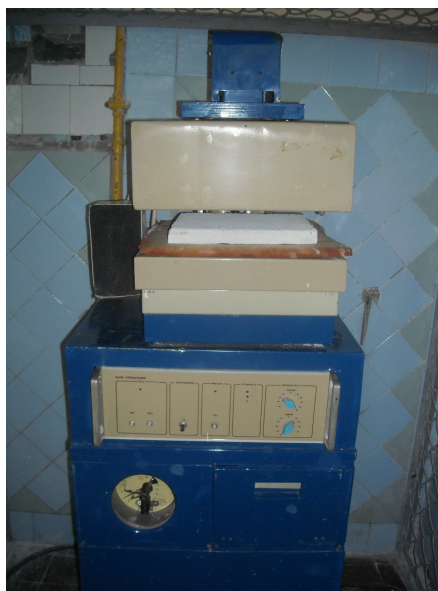
Рис. 5.4. Установка ИТСМ-1 для определения теплопроводности строительных материалов
