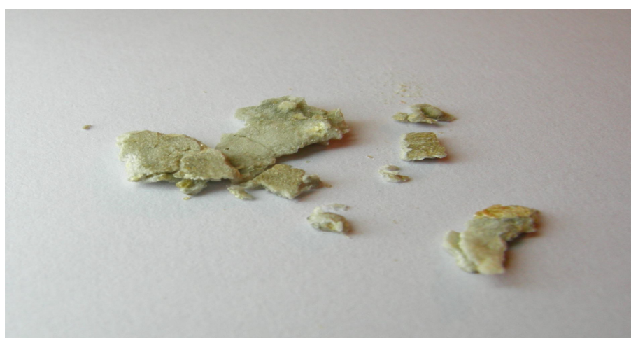
Рис. 3.2. Внешний вид геля, образованного из смеси карбоната калия и силиката натрия
