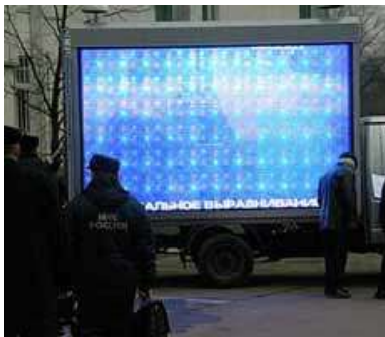
Рис. 3. Мобильный комплекс информирования и оповещения населения (МКИОН)
