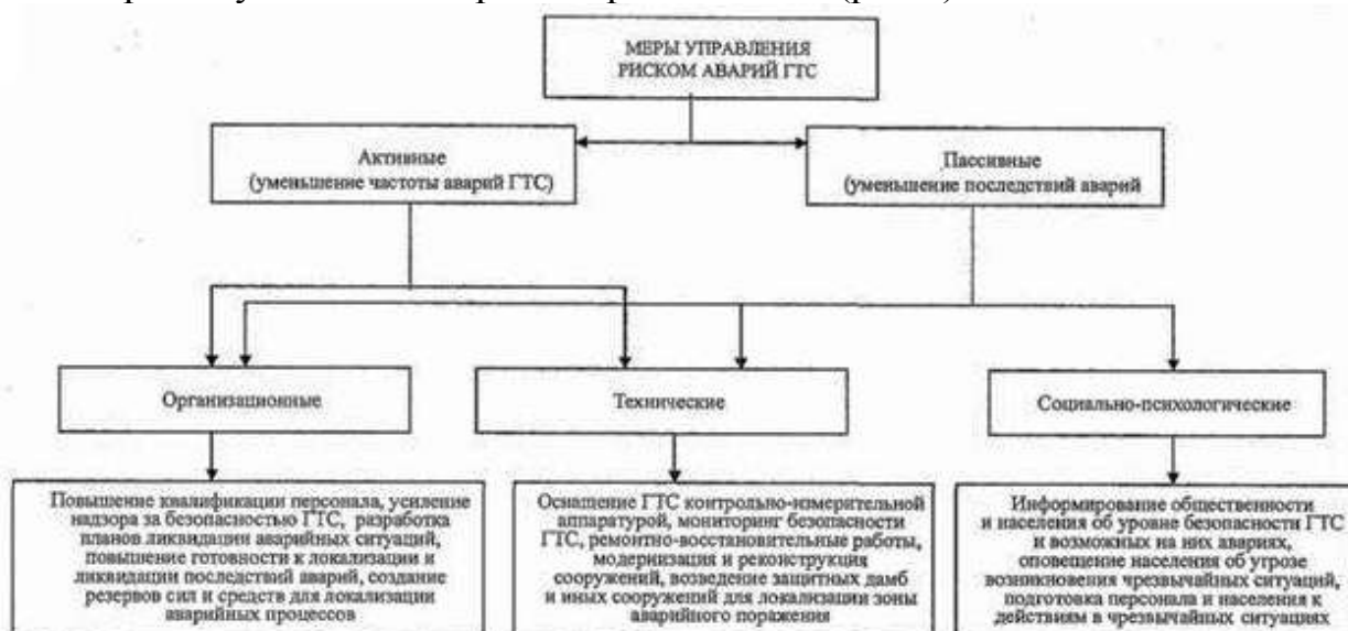
Рис.1 Возможные меры управления риском аварий гидротехнических сооружений
