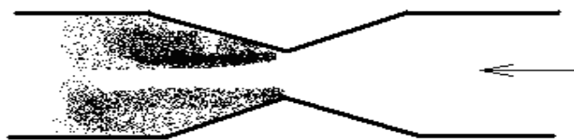
Рис. 1 – Образование кавитационной области при движении жидкости в трубе
