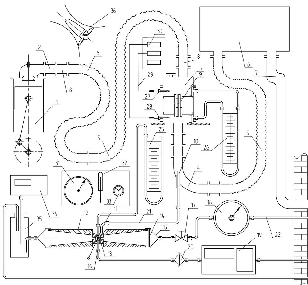
Рис. 1. Схема системы отбора проб ОГ на токсичность МИС:
