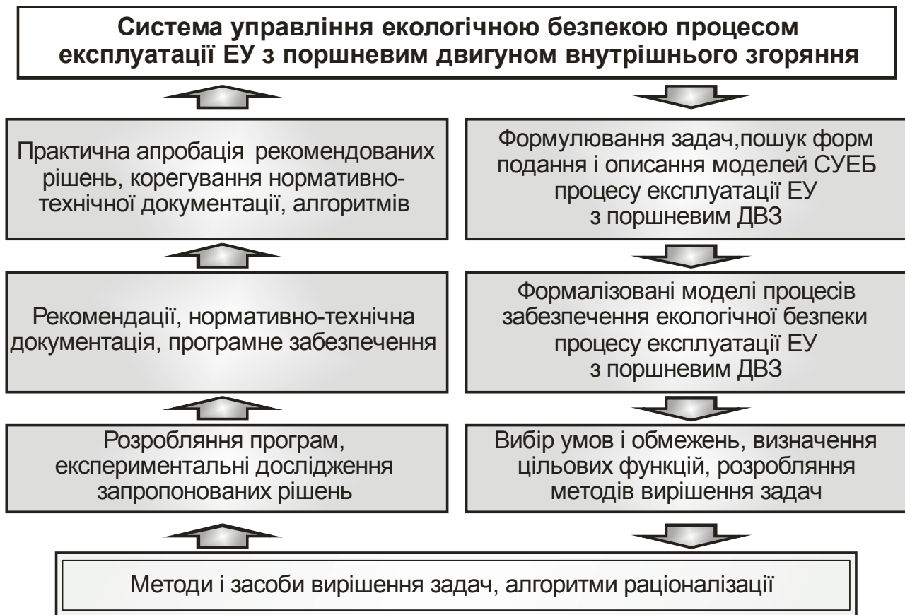
Рис. 4.1. Алгоритм побудови СУЕБ процесу експлуатації ЕУ з поршневим ДВЗ
