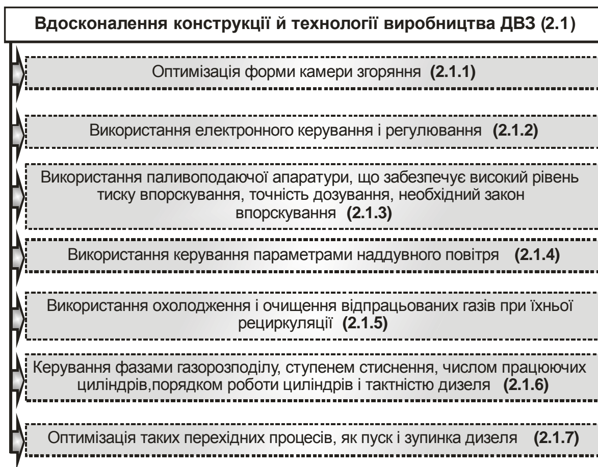
Рис. 2.6. Класифікація способів зниження токсичності відпрацьованих газів ДВЗ при вдосконаленні конструкції ДВЗ
