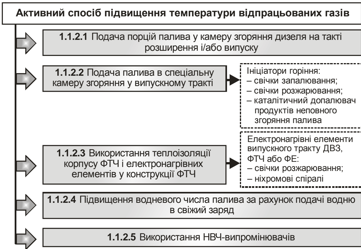
Рис. 3.18. Заходи активного підвищення температури відпрацьованих газів при регенерації I роду термічним або термокаталітичним способом
