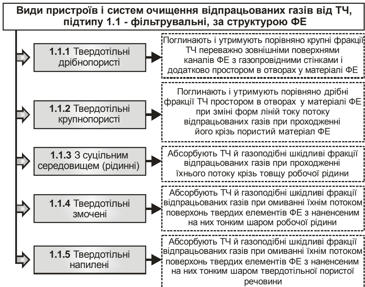
Рис. 2.11. Поділ пристроїв і систем очищення відпрацьованих газів від ТЧ підтипу – фільтрувальні за структурою ФЕ на види
