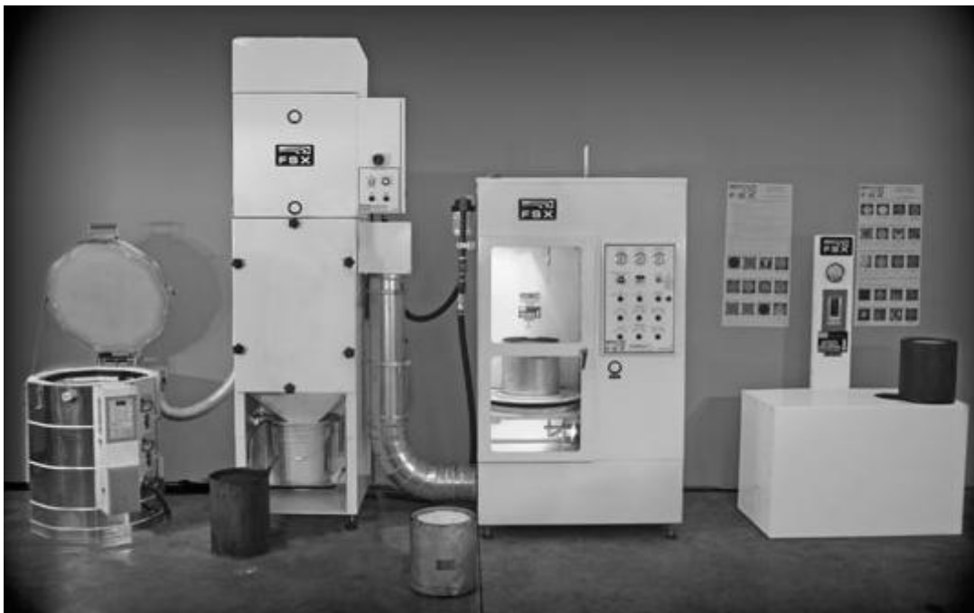
Рис. 3.32. Стационарний стенд для регенерації II роду ФТЧ FSX Complete Cleaning Package [637]
