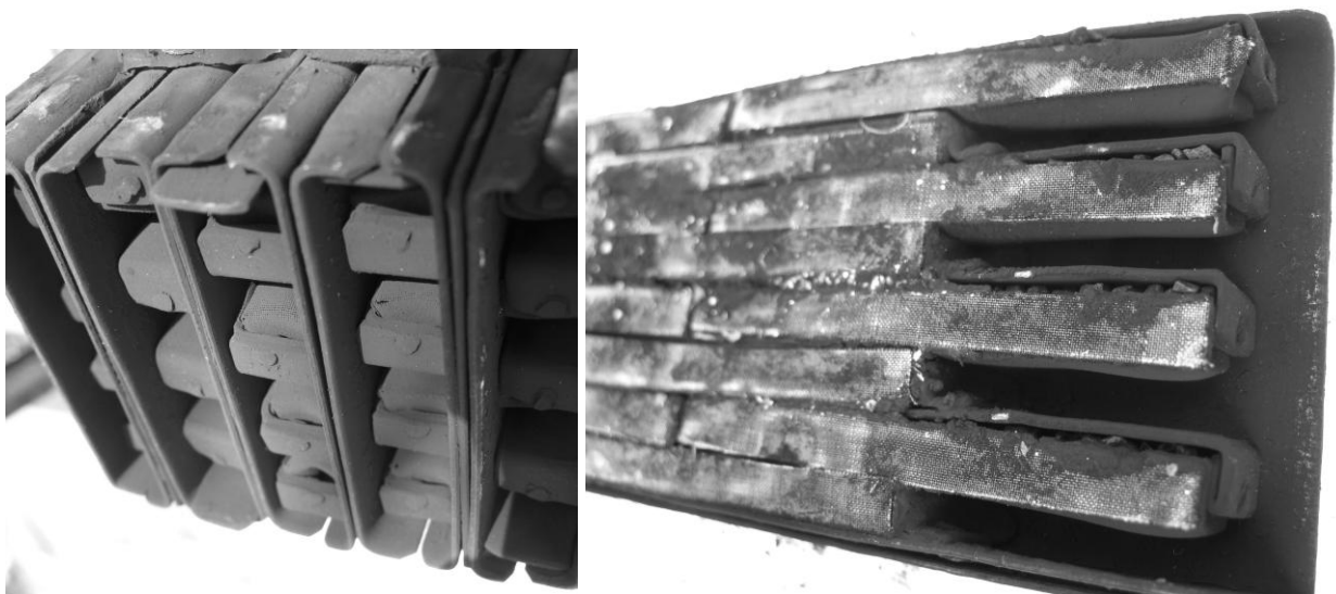
Рис. 2.37. Зовнішній вигляд поверхонь діючого зразка ФЕ ФТЧ ІПМаш після моторних випробувань у реальних умовах експлуатації [69, А.4.22, А.4.23]
