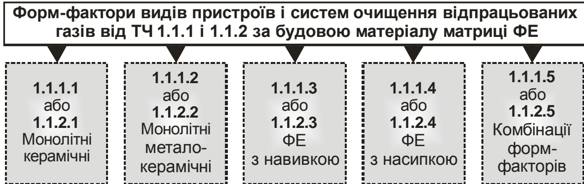
Рис. 2.12. Поділ видів пристроїв і систем очищення відпрацьованих газів від ТЧ на форм-фактори за будовою матеріалу матриці ФЕ
