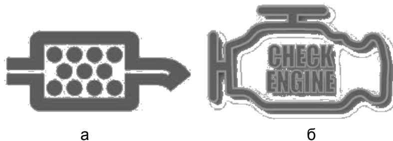
Рис. 3.27. Типовий вигляд індикаторів панелі приладів АТЗ: а – «Check DPF»; б – «Check Engine» [631]
