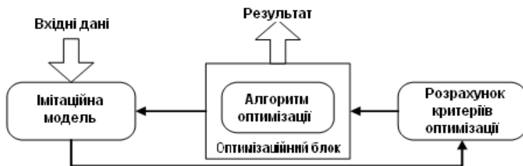
Рис. 1. Схема розв'язання задач оптимізації виробничих процесів
