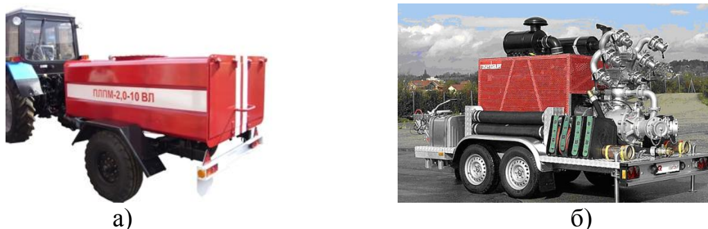
Рис. 2. Примеры пожарных прицепов зарубежного производства: а – прицеп пожарный (прицепной лесопожарный модуль) ПЛПМ 2.0-10ВЛ; б – SLA-6000 Fjomatic;
