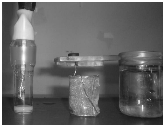
Рис. 2. Электрохимическая ячейка с анализируемым раствором в рабочем состоянии. Слева направо: вспомогательный электрод, рабочий электрод, ячейка с анализируемым раствором
