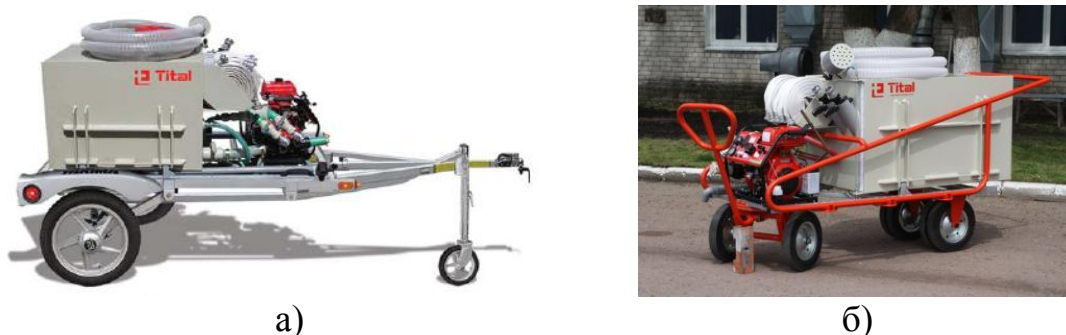
а) б) Рис. 1. Мобильный пожарный модуль МПМ-0,7-7 "БРИЗ": а – вариант на полуприцепе; б – вариант на тележке
