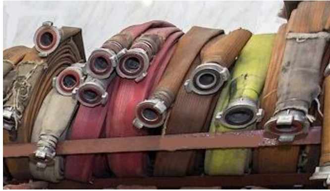
Рисунок 1 - Размещение напорных пожарных рукавов в отсеке пожарного автомобиля
