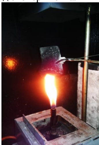
Рисунок 1 – Общий вид экспериментальных исследований по ГОСТ 16363
