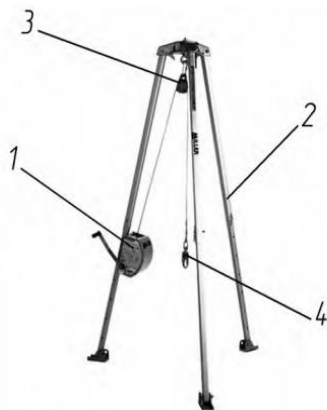
Рисунок 1 – Устройство треноги 1 – механизм подъема; 2 – тренога; 3 – блок; 4 – крюк
