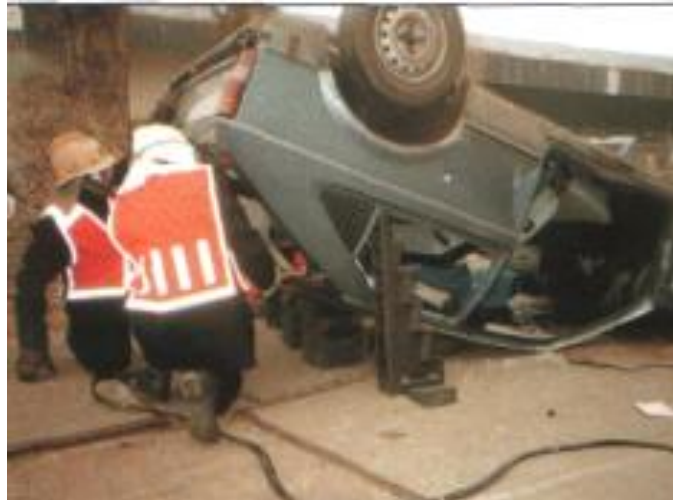
Рис. 7.20. Фіксація перекинутого автомобіля
