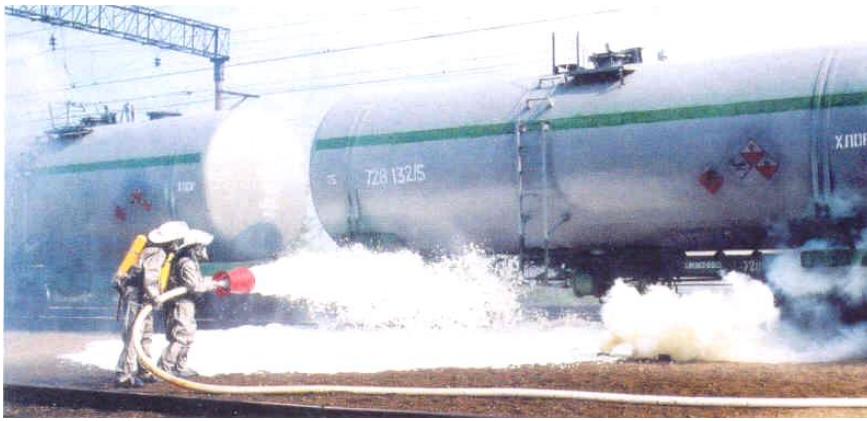
Рис. 5.3. Накриття шаром піни місця розливання НХР
