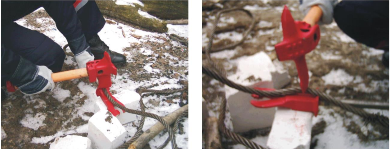
Рис. 4.23. Перебивання тросу інструментом ІРАР
