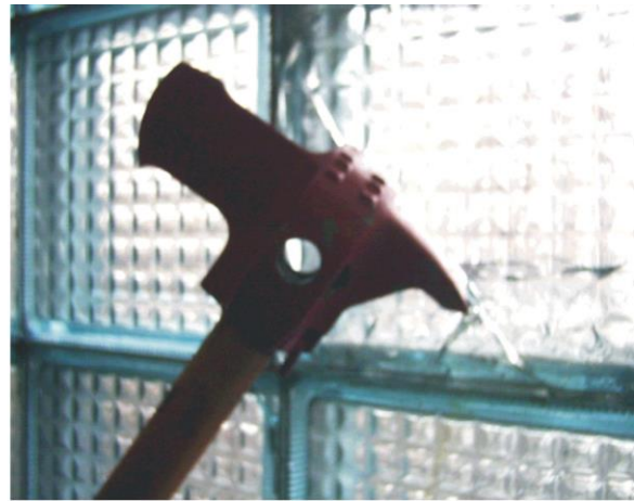
Рис. 4.20. Виготовлення отворів за допомогою інструменту ІРАР
