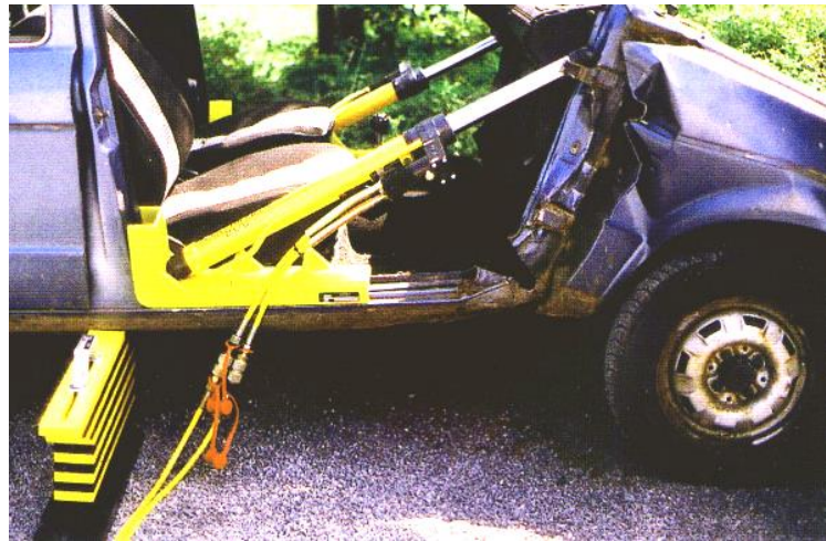
Рис. 7.21. Віджимання передньої частини автомобіля
