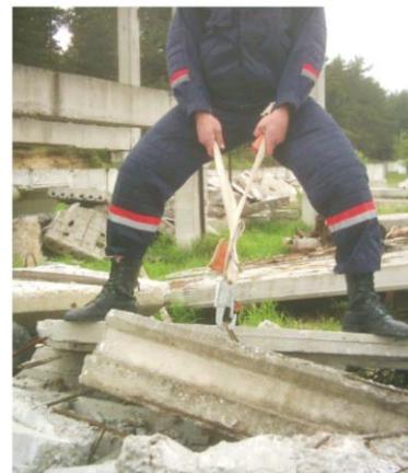
Рис. 4.27. Підняття за допомогою інструменту ІРАР
