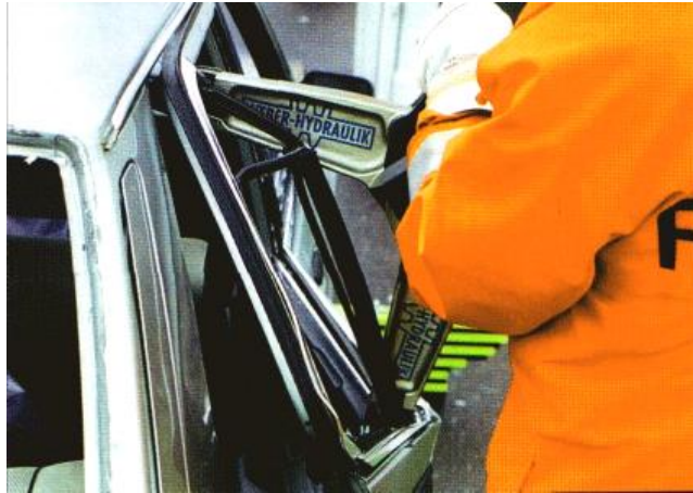
Рис. 7.12. Розширення віконного прорізу дверей
