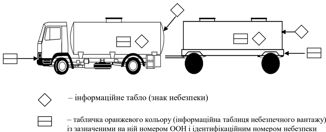
Рис. 7.27. Приклад маркування автотранспортного засобу
