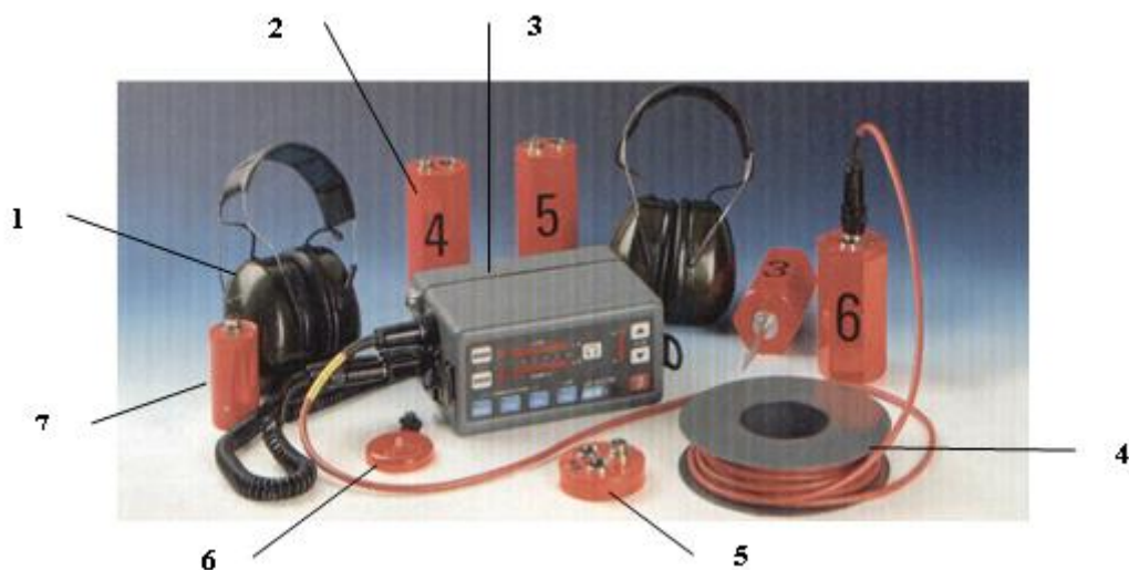
Рис. 6.15. Загальний вигляд геофону: 1) навушники; 2) датчики; 3) пульт; 4) катушка з кабелем; 5) розгалуження; 6) приймач речового сигналу; 6) магнит
