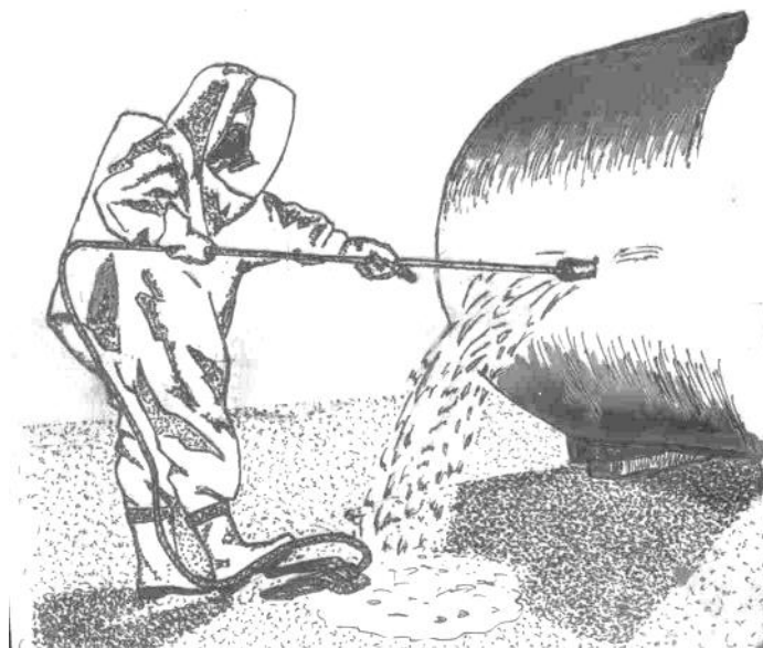
Рис. 5.10. Затискання пробоїни пневматичною заглушкою
