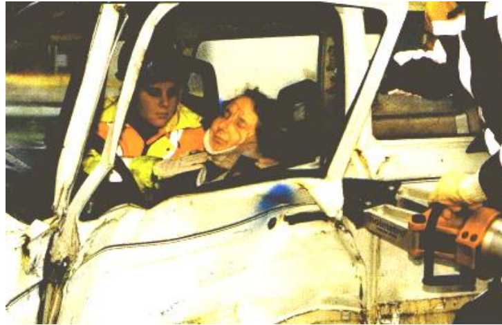
Рис. 7.11. Відкриття дверей для вилучення постраждалого
