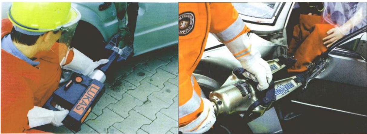
Рис. 7.13. Технологія видалення передніх дверей
