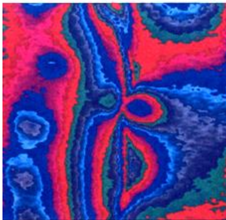
Рис. Голограма деталі під механічним навантаженням
