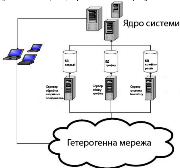
Рис. 1 – Функціональна схема інтелектуальної системи управління
