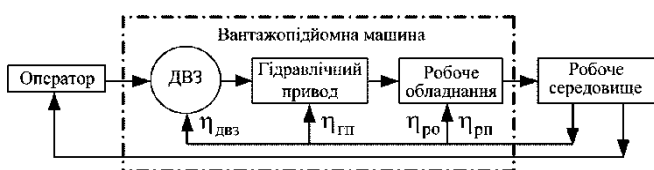
Рис. 4 – Структурна схема землерійної машини (вантажопідіймна машина - кран) при взаємодії оператора і машини з робочим середовищем
