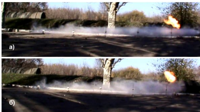
Рисунок 1 – Фотографии полета высокоскоростной струи огнетушащего вещества:
