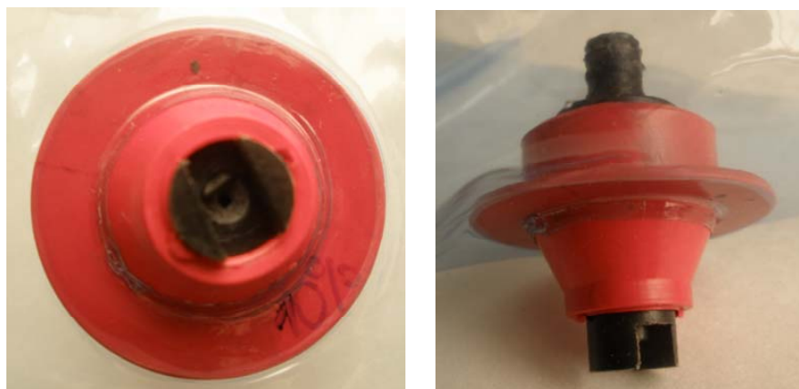
Рисунок 2 – Газовый обратный клапан, термически сваренный с ПВХ пленкой резервуара ПШ
