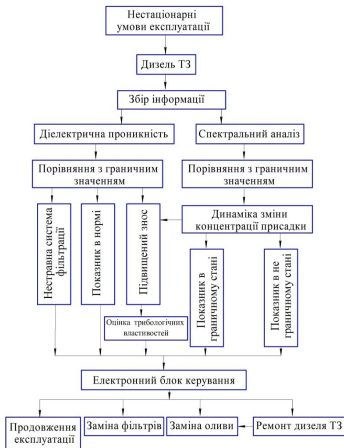
Рисунок 3 – Технологія діагностування та заміни моторної оливи дизеля ТЗ за її фактичним станом
