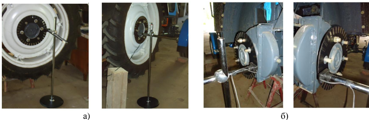
Рисунок 3 – Место установки датчиков и дисков со светоотражающими метками на тракторе ХТЗ-3512
