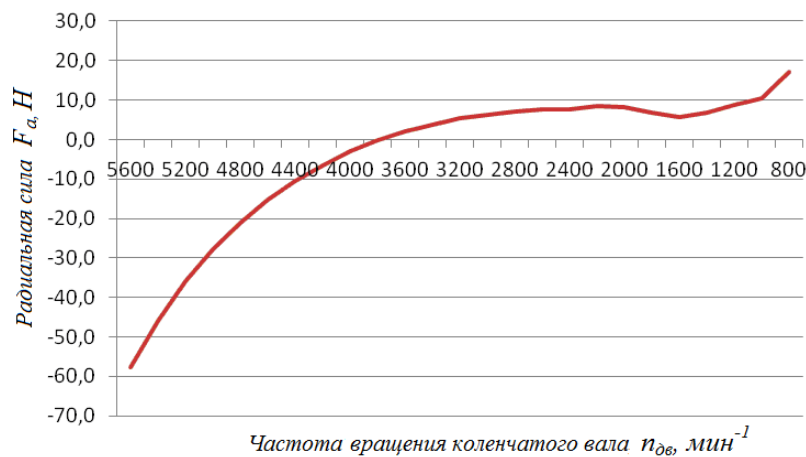
Рисунок 2 – Расчетная зависимость изменения радиальной силы от частоты вращения коленчатого вала двигателя
