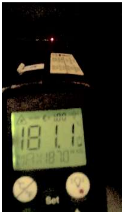
Рис. 4. Процес вимірювання температури корпусу пристрою (30 хв з початку розпалу)
