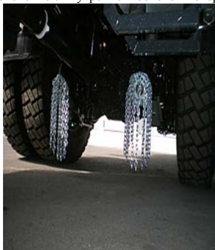
Рисунок 1 – Система Rotogrip в транспортном положении
