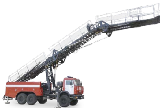
Рисунок 1 – Пример работы мобильного трапа
