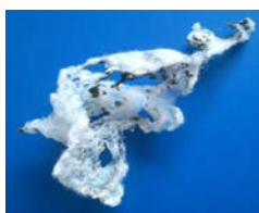
Рисунок 1 – Образцы полиэфирного утеплителя, обработанные композицией АН-10 после огневого испытания
