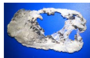
Рисунок 2 – Образцы полиэфирного утеплителя, обработанные композициями CuАН 6,5-20 и CuАHS-10 после огневого испытания
