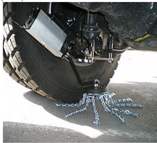
Рисунок 2 – Система Rotogrip в рабочем положении
