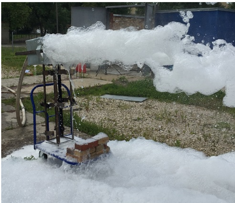
Рисунок 2 – Генератор пены высокой кратности в работе
