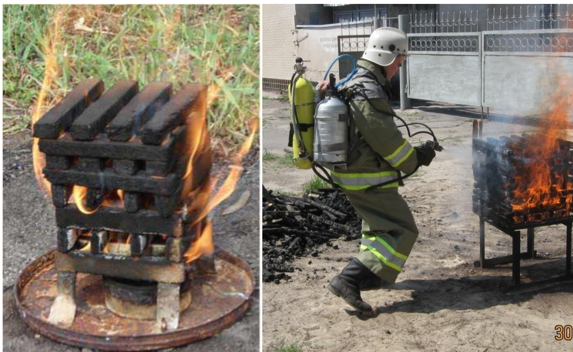
Рисунок 1: а) – Модельный очаг из ДВП (по стандарту класс 1А); б) – дотушивание модельного очага 1 А установкой «АУТГОС П»
