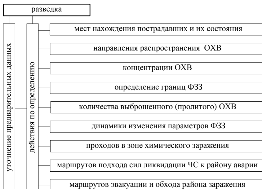
Рисунок 2 – Разведка при проведении аварийно-спасательных работ
