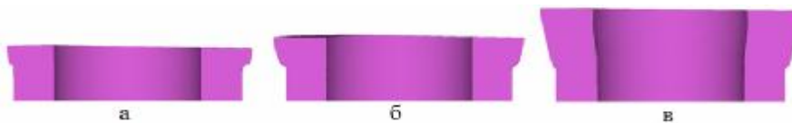
Рис. 2. Формозміна заготовки за трьома варіантами відносних висот: а – при відносній висоті 0,6; б – 1,0; в – 2,0
