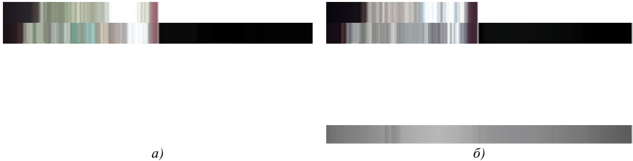
Рис. 1. Світлорозподіл ближнього світла ламп розжарювання Osram +30% 60/55 (а) і Pulso 60/55 (б)
