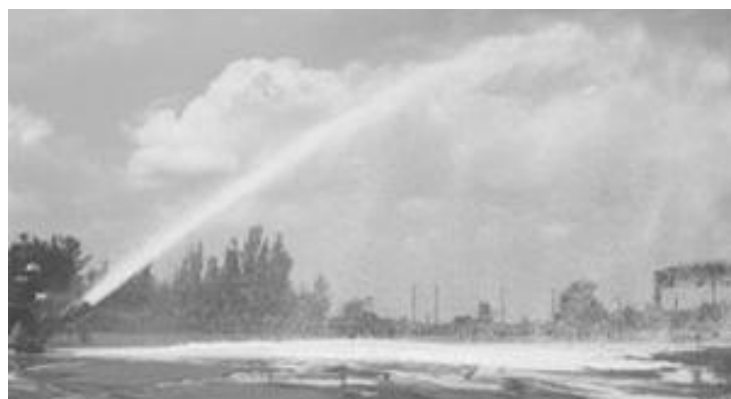
Рисунок 9.37. Подання струменя ПМП з УГПС-1200 (максимальна дальність)
