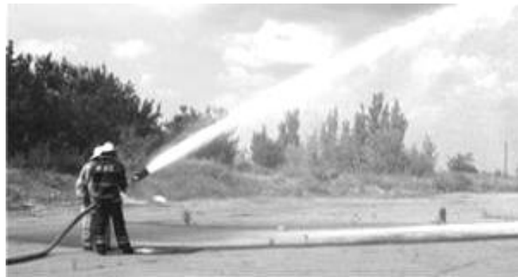
Рисунок 9.25. Подання струменя ПМП з УГПС-100 (максимальна дальність)
