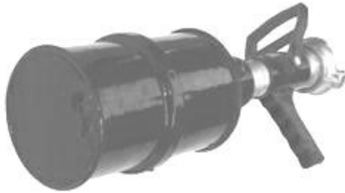
Рисунок 7.15. Переносний (пожежний) ствол СРП-50Е з насадком піни середньої кратності
